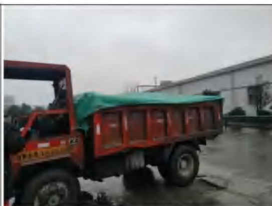
运输车辆覆盖处理
